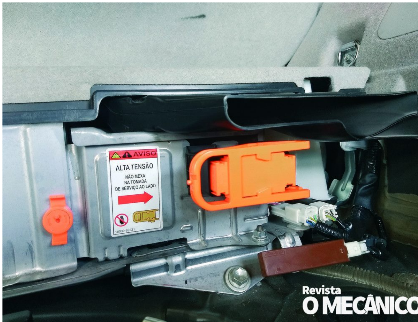
Chave de segurança da bateria de tração é identificada pela cor laranja
