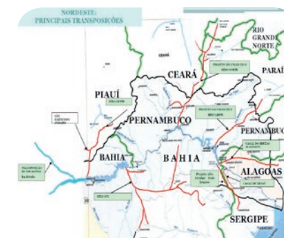
Canais de transposição das águas do Rio São Francisco
